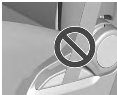
Posição incorreta do cinto de segurança.
